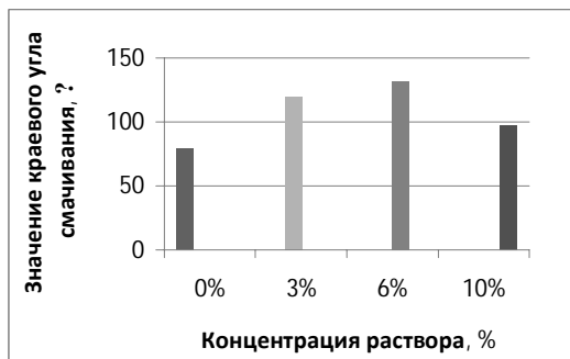
Рисунок – Зависимость краевого угла смачивания гидрофобизированных лакокрасочных материалов от концентрации раствора полидиметилсилоксана в бензоле
