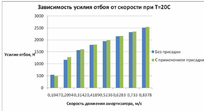
Рисунок – Зависимость усилия отбоя от скорости при T = 20°C
