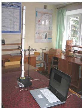
Рисунок – Экспериментальная установка для определения ускорения свободного падения
