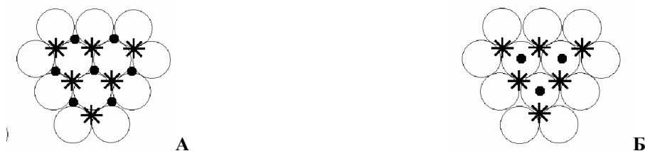
Рисунок 1 – Два типа плотнейшей упаковки шаров: А) ГПУ; Б) ГЦК. Центры шаров второго слоя обозначены (*), третьего (●)
