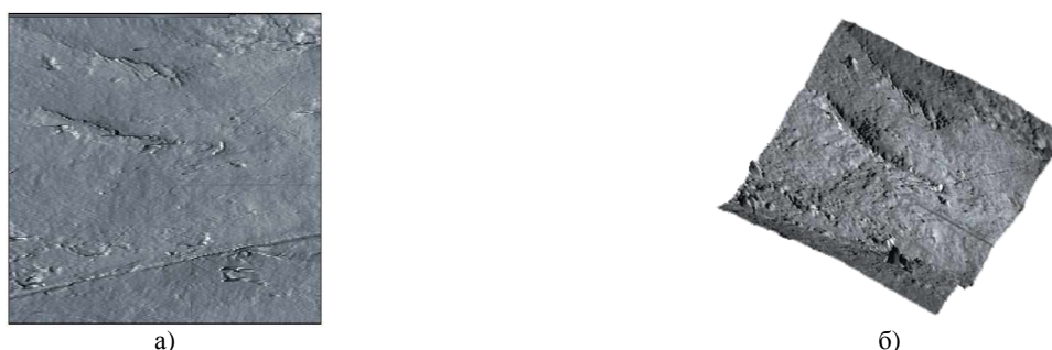
Рисунок 2 – АСМ-изображение композиционного покрытия ПА6+УПТФЭ, поле сканирования 10 \times 10 мкм а – топография поверхности; б – трехмерное изображение поверхности
