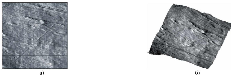
Рисунок 1 – АСМ-изображение композиционного покрытия ПА11+УПТФЭ, поле сканирования 10 \times 10 мкм а – топография поверхности; б – трехмерное изображение поверхности
