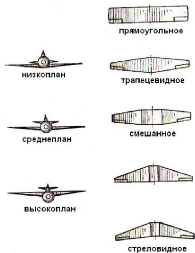
Рисунок 3.10 – Основные схемы расположения крыла и их форма
