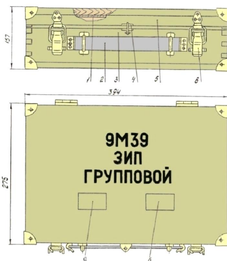
Рисунок 1.91 – Ящик для группового комплекта ЗИП ракеты 9М39: 1 – указатель; 2 – ручка; 3 – корпус; 4 – пломба; 5 – крышка; 6 – замок; а – индекс предприятия-изготовителя; б – год изготовления
