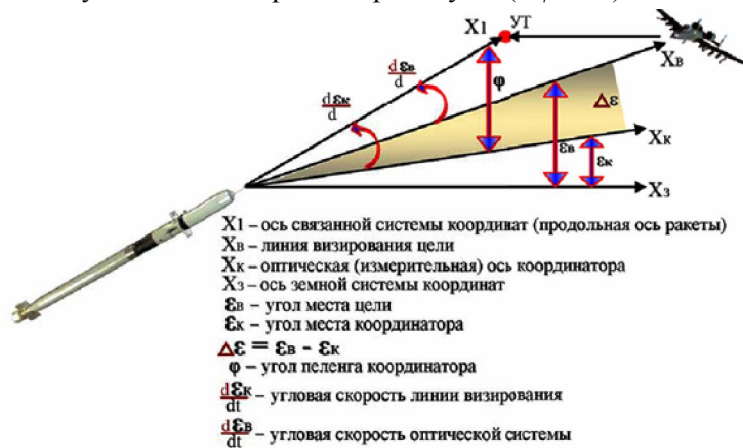
Рисунок 1.25 – Работа следящей системы координатора цели
