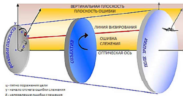
Рисунок 1.17 – Принцип формирования изображения цели и ошибки слежения
