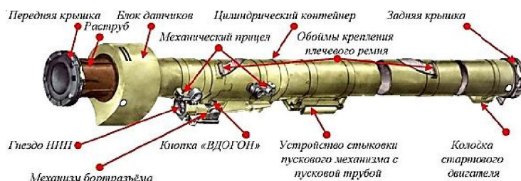
Рисунок 1.49 – Устройство пусковой трубы
