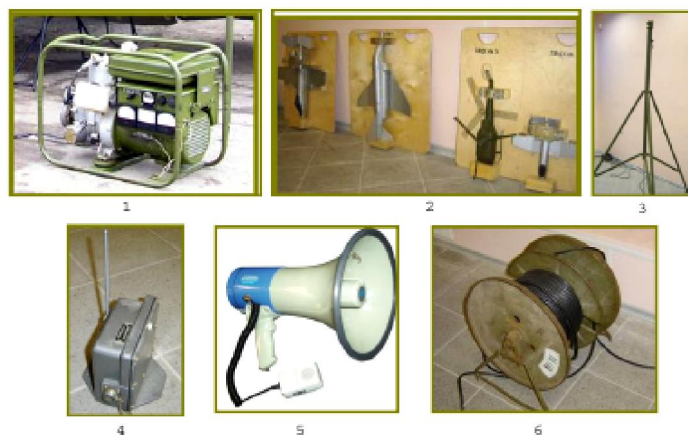
Рисунок 1.70 – Элементы УПТ 9Ф635: 1 – агрегат электропитания; 2 – макеты воздушных целей; 3 – мачта изменяемой высоты; 4 – датчик параметра; 5 – электромегафон; 6 – катушка с кабелем
