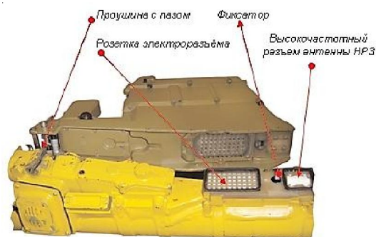
Рисунок 1.57 – Устройство стыковки пускового механизма с пусковой трубой
