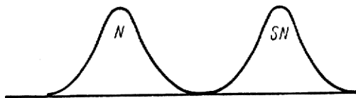
Рис. 11. Распределение шума (N) и сигнала плюс шум (SN) для сильного сигнала
